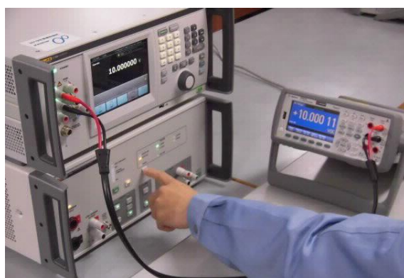
発生部（高精度電圧電流発生機能）（左）によるデジタル電圧計（右）の校正
